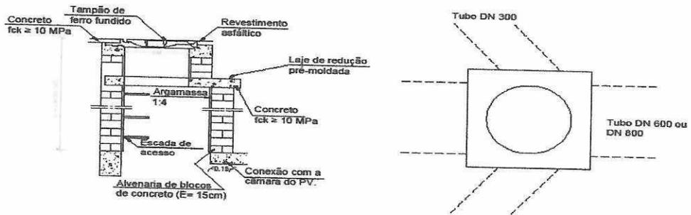
POÇO DE VISITA S/ ESCALA - CORTE E PLANTA
